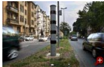
Rundumsicht: Die Messanlage in der Säule erfasst Raser in fast allen Winkeln
